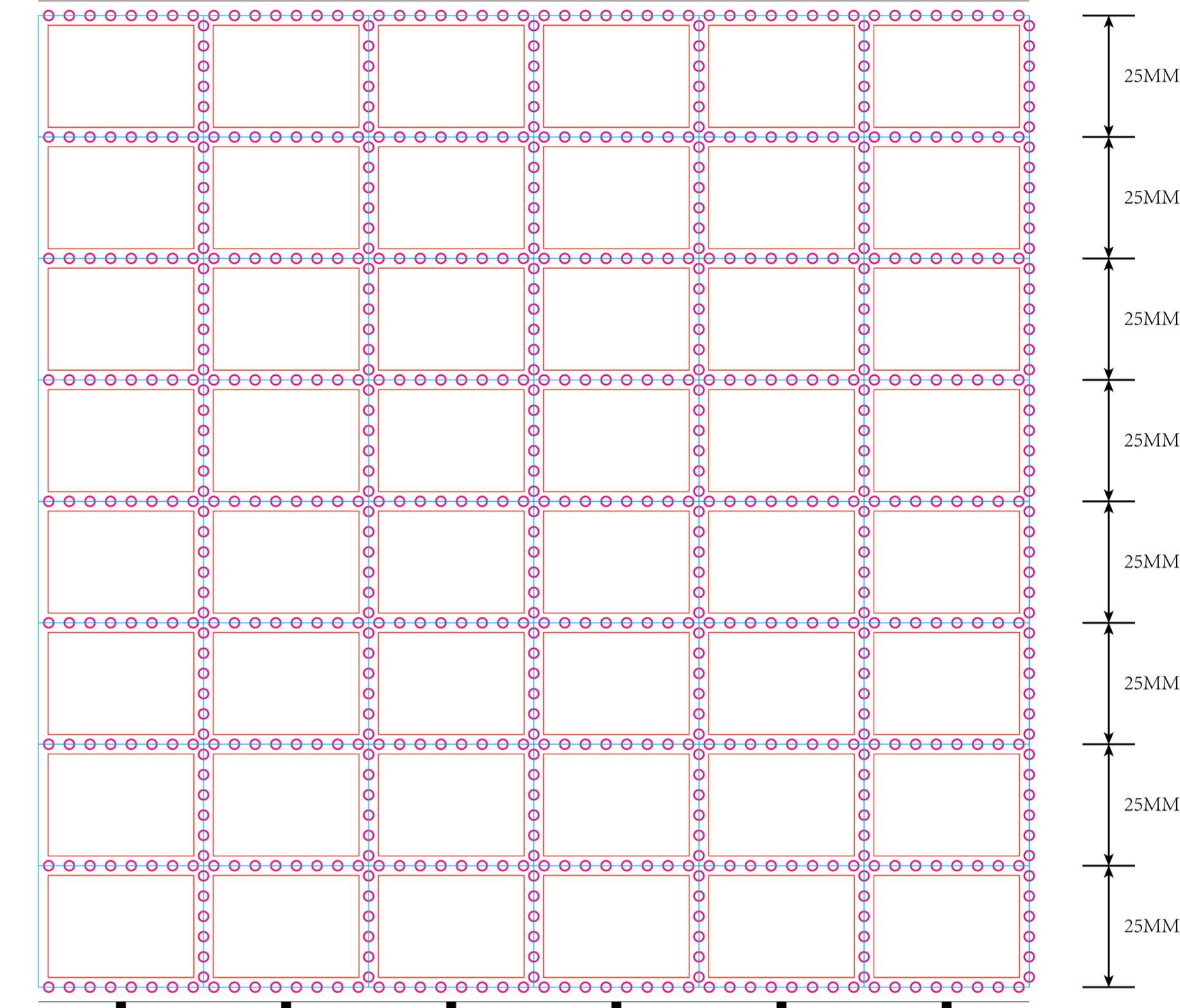
版宽: 238mm x 203MM 单刀 (烫金) 孔径2MM
